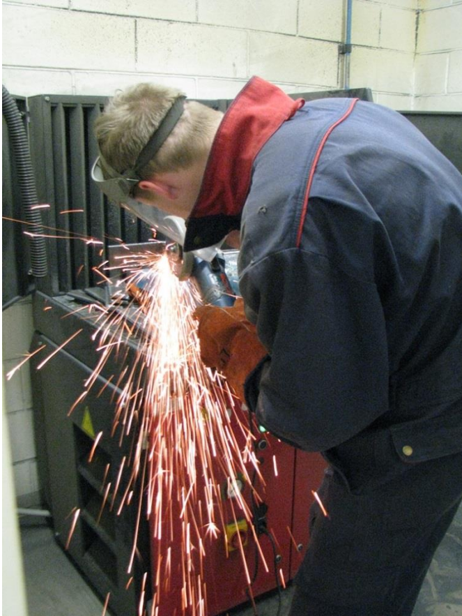
Foto 25 Tuletöö tegemine (ketaslõikuriga metalli lõikamine) Foto: Kull, A. 2014
