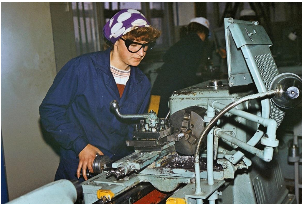
Foto 7 Naine treialiametit õppimas. Ainus foto, millel töötaja kasutab silmi ohustaval tööl kaitseprille
